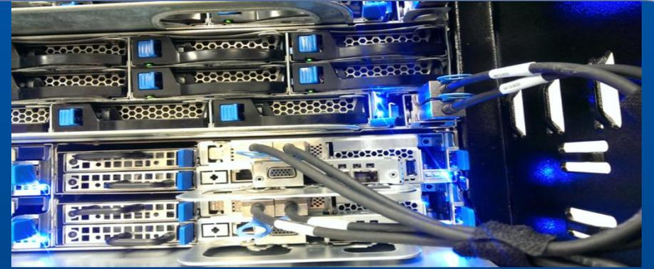
HDD, I/O およびPSUはすべて前面のコールドアイル側からの保守作業が可能
