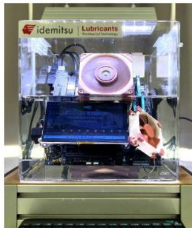
「IDEMITSU ICF シリーズ」による液浸冷却の様子 （試験機）
