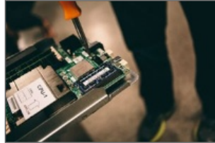
写真1 ● マザーボードの右上にあるのが、今回開発したFPGA搭載のデータボード [画像のクリックで拡大表示]
