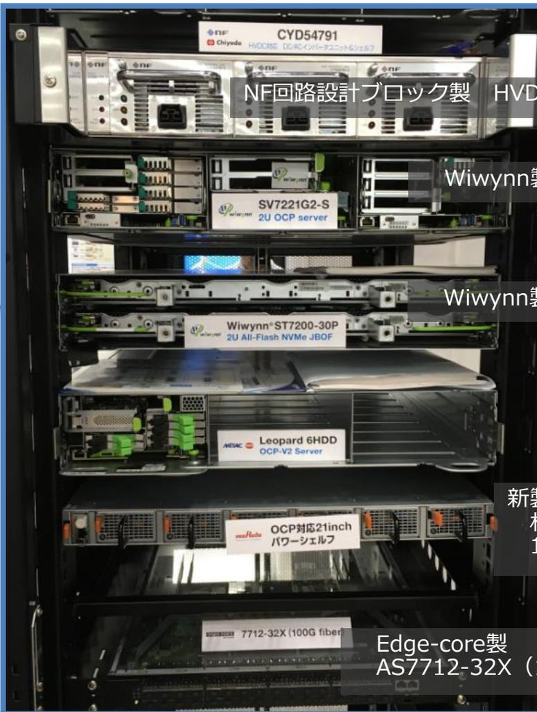
NF回路設計ブロック製 HVDCインバータ 2U/20U
